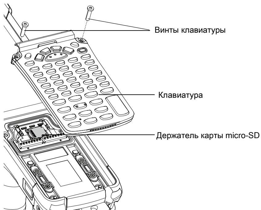
Рис. 5 Снятие клавиатуры
