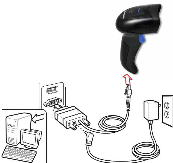
Рис. 3. Подключение по интерфейсу RS-232
