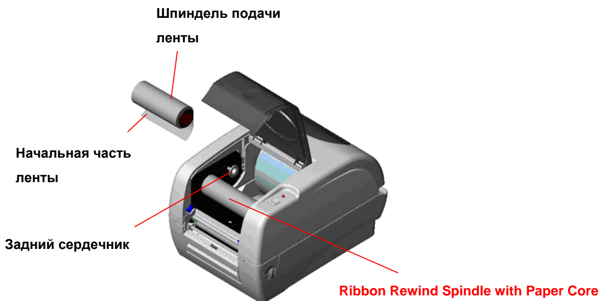
Рис. 5 Установка ленты (II)
