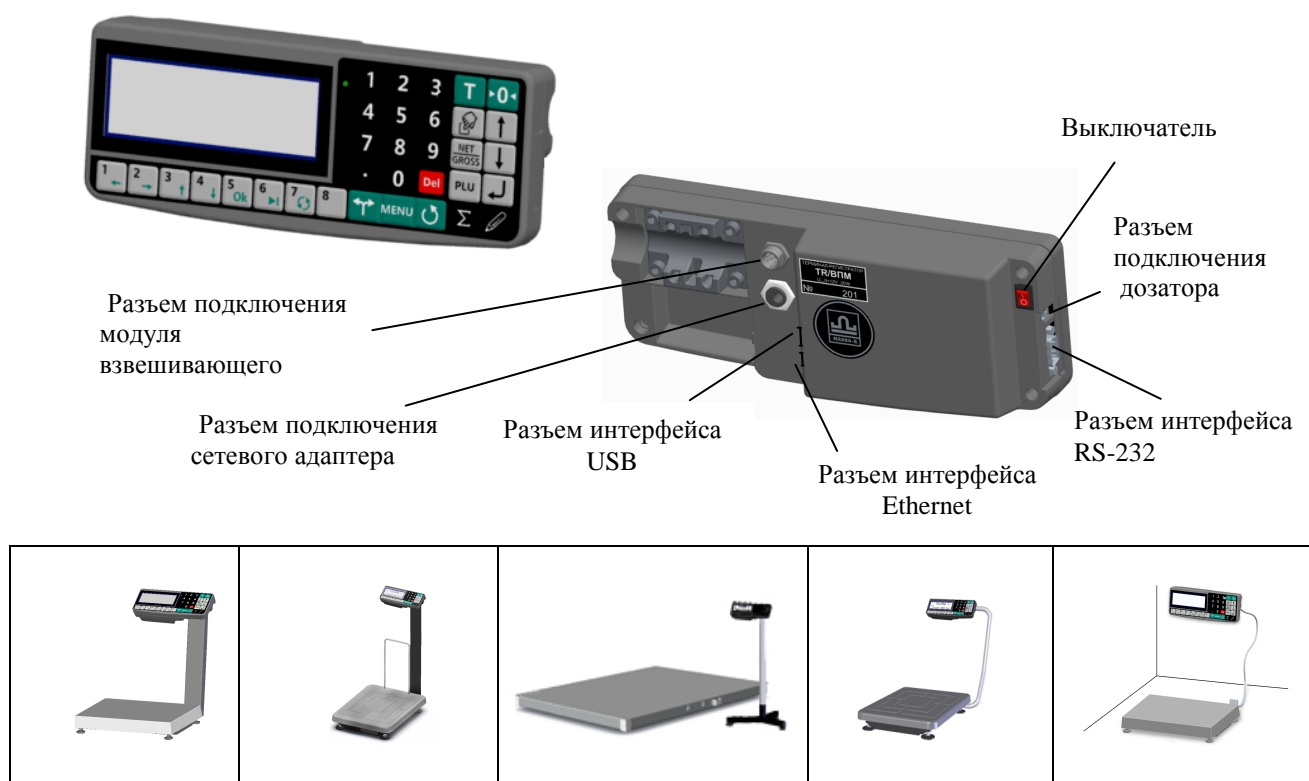
Рис. 2.1 - Общий вид терминала RA, примеры использования
