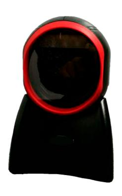
Proton IDS-1290 — многоплоскостной 2D-сканер, способный считывать все основные 1D и 2D коды. Настольный сканер выдерживает падение с высоты до 1,2 метров. Скорость сканирования достигает 2500 скан/сек. Кроме того, IDS-1290 поддерживает сканирование штрих-кода с телефона, экрана, металла и пластика.
